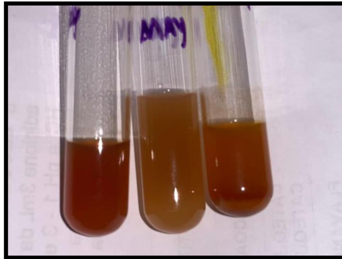
Figura 16. Formação de precipitado pelos reagentes de Bouchardt, mayer e Dragendorff. Fonte: Autor.
