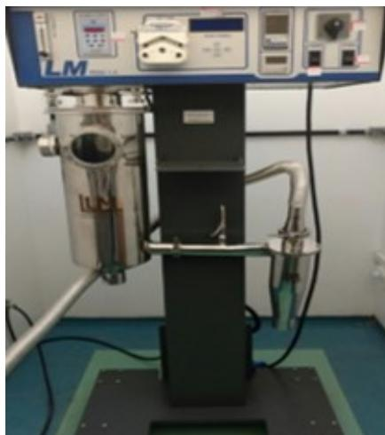
Figura 22: *Spray dryer*: LM – MSDi 1.0 Labmaq do Brasil – LTDA (Arquivo pessoal)
